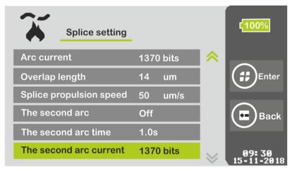
Figure 21. Splice Parameters Menu (b).
