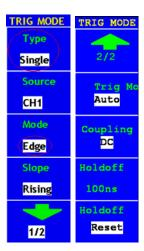
Figure 39. Edge trigger menu.
