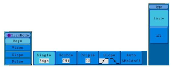
Figure 33. Edge trigger menu.
