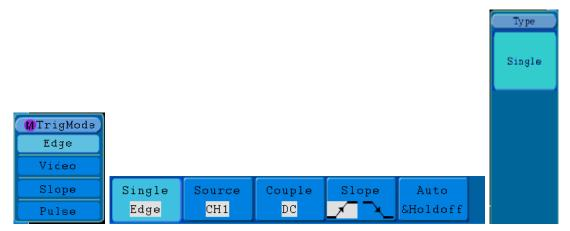
Figure 30. Edge trigger menu.
