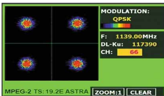
Figura 48.- Diagrama de constelación. Señal DVB-S (QPSK).
