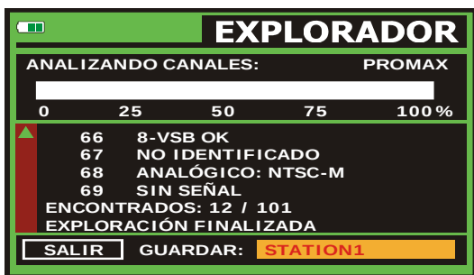
Figura 18.- Pantalla de exploración del espectro. EXPLORER.
