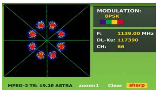
Figura 49.- Diagrama de constelación. Señal DVB-S2 (8PSK).
