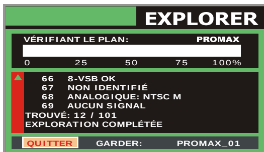
Figure 18.- Écran d'exploration de spectre. EXPLORER.
