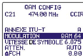
**Figure 21.-** Configuration de mesures pour signaux numériques.
