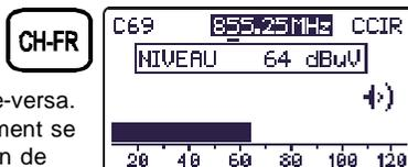
Figure 22.- Syntonie par fréquence.
