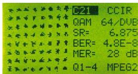
**Figura 20.-** Representación del Diagrama de la Constelación y medidas del BER y MER de un canal digital.
