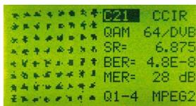
**Figure 20.-** Représentation du Diagramme de la Constellation et les mesures du BER et MER d'un canal numérique.
