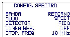
Para modificar un parámetro girar el selector rotativo [9] hasta activarlo (éste aparece sombreado) y a continuación pulsar el selector; el valor actual del parámetro se activará y se podrá modificar girando el selector. Una vez aparezca el valor deseado, pulsar el selector rotativo [9] para validarlo.
