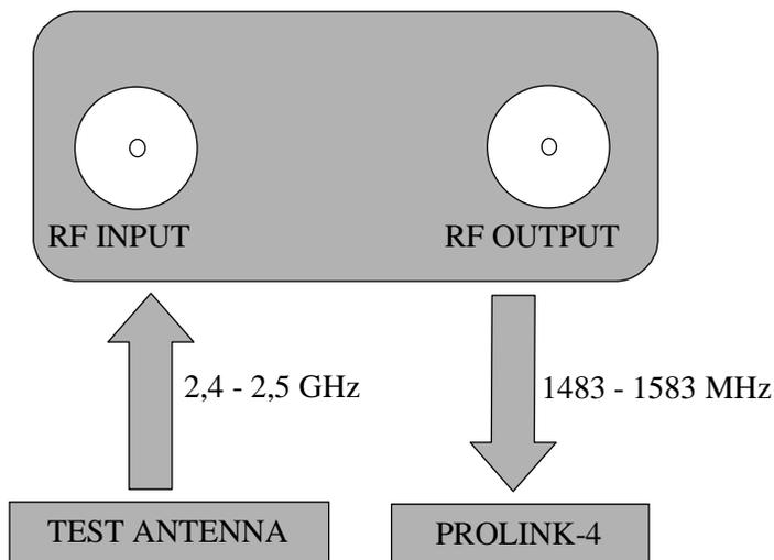
En primer lugar es necesario conectar la salida de RF del convertidor al analizador de espectros utilizando el cable coaxial que se suministra. La fuente de señal o la antena de pruebas deben conectarse a la entrada de RF para finalmente alimentar desde el analizador de espectros. Si el CV-245 se utiliza con un medidor de campo PROLINK-2+, PROLINK-3/3C *Premium* o PROLINK-4/4C *Premium* la indicación de "drain" sobre el analizador de espectros confirmará que el convertidor está activo.
