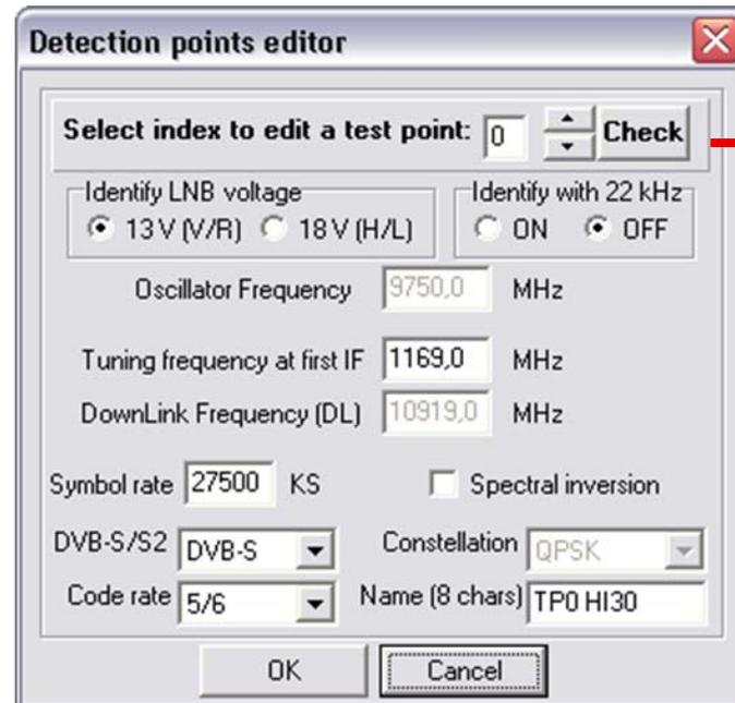
Avant de passer au point de test suivant, vous devez cliquer sur le bouton "Check" afin de valider la configuration.
