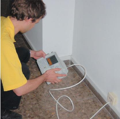
Nun sind die Geräte einsatzbereit. Der **RP-080** wird vom TV Explorer getrennt und anstelle der Antennen an die Kopfstation angeschlossen. Dort bleibt er, während man das TV Explorer zu den vorgesehenen Messpunkten im Gebäude mitnimmt.
