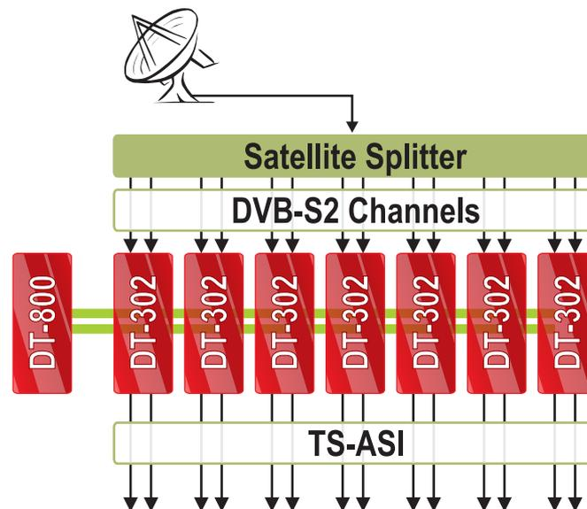
Verschlüsselte HDTV Kanäle können direkt an der Kopfstation decodiert werden, dazu ist ein CA-Interface in den **DT-302** Modulen eingebaut.
