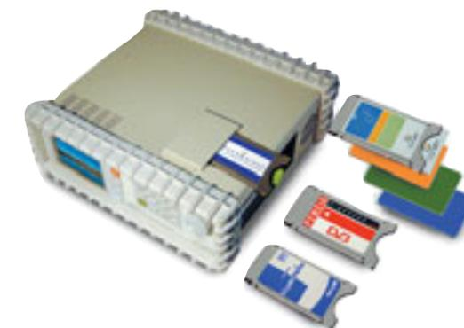
módulos de acceso condicional (CAM) y sus correspondientes tarjetas 'Smart-Card'. Esto permite al usuario acceder a los contenidos de televisión digital de distintos proveedores, incluso si utilizan diferentes sistemas de encriptación. El uso de 'Common Interface' en equipos de medida es una función patentada por **PROMAX**.
