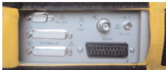
El conector de entrada es de tipo reemplazable (\*\*), de modo que permite un cambio fácil según la aplicación o en caso de avería del conector. Los equipos se entregan con conectores BNC-TV-F (\*\*).
