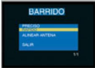
Combinan las ventajas de equipos de alta precisión, mediante el modo de barrido 'Preciso', con las de analizadores en tiempo real, en el modo de barrido 'Alinear antena'.
