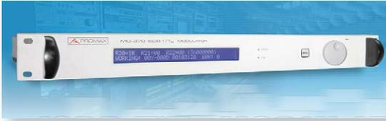
El **MO-370 LE** es un modulador ISDB-T e ISDB-T<sub>B</sub> de propósito general construido sobre un chasis 1U de 19". Dispone de dos entradas serie MPEG TS-ASI. Cualquiera de las dos señales puede utilizarse para modular la señal COFDM. Una señal adicional test TS puede ser generada internamente. Ésto permite introducir señales compatibles con el estándar ISDB-T/TB incluso en ausencia de una entrada TS válida.
