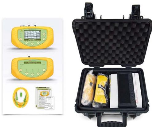
Semplifica la certificazione del cablaggio in fibra negli edifici con questo strumento. Consente a un singolo operatore di certificare tutte le prese ottiche. La sorgente luminosa **PROLITE-105**, collegata all'ingresso in fibra ottica dell'edificio, genera automaticamente i segnali pilota. L'operatore usa poi il misuratore FTTH **PROLITE-67** per verificare la potenza ottica in ricezione in ogni presa.
