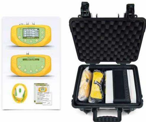
Diseñado para la certificación del cableado de fibra en edificios. Permite a un solo operario certificar todas las tomas ópticas conectando la fuente de luz (**PROLITE-105**) a la entrada de fibra óptica del edificio y generando las señales piloto automáticamente, mientras el operario verifica la potencia óptica recibida en cada una de las tomas utilizando el medidor FTTH (**PROLITE-67**).
