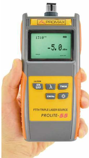
La fuente LASER modelo PROLITE-55 genera las tres longitudes de onda requeridas en la ICT-2 (1310 nm, 1490 nm y 1550 nm) con una estabilidad excelente que asegura una medida precisa en FTTH. Potencia de salida ajustable en pasos de 0,1 dB.
