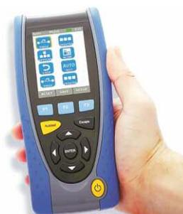
El IC-081 es un mapeador de hilos avanzado y versátil totalmente compatible con PoE e IPv6 y 802.1x. Es una herramienta eficaz para solucionar los problemas que se pueden encontrar en redes de telecomunicaciones activas y pasivas de cobre y fibra óptica que incluye en un solo aparato las capacidades avanzadas de varios verificadores de cableado.
