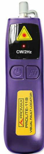
Utiliza una fuente LASER con una potencia óptica de 30 mW que funciona en modo continuo o modulado (2 Hz). Su salida universal está protegida para evitar accidentes.
