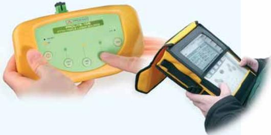
**Ejemplo: Certificación de una instalación utilizando los kits PL-675 o PL-775**
