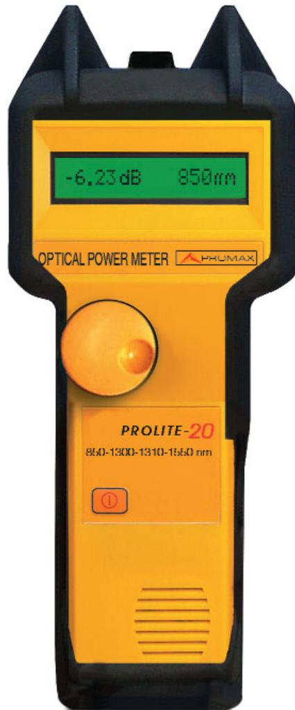
Los **PROLITE-20/21** son medidores de potencia óptica con una curva de medida ponderada para diferentes longitudes de onda entre 820 y 1650 nm y un margen dinámico de medida de -70 dBm a +5 dBm para la opción **PROLITE-21** y -50 dBm a +25 dBm para la opción **PROLITE-20** en aplicaciones de TV Cable y medidas en amplificadores EDFA (Erbium Doped Fiber Amplifier).
