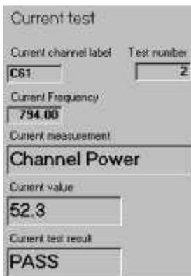
Muestra los datos del prueba que está realizando el PROLINK-4 en cada momento. El programa sintoniza el PROLINK-4 a la frecuencia y medida seleccionada previamente en el menú de “Channel configuration”. El resultado de esa medida es entonces comparado con los límites de aceptación. Si es válido el resultado será PASS y será FAIL en caso contrario.
