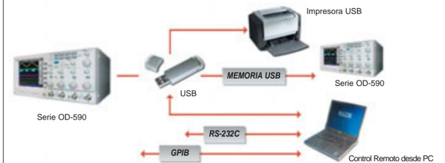
En la memoria interna se pueden guardar hasta 20 formas de onda, 20 configuraciones del panel de control y 4 ondas de referencia, para su posterior recuperación y visualización. Todos los datos pueden ser guardados o recuperados mediante una memoria USB utilizando el puerto USB HOST.
