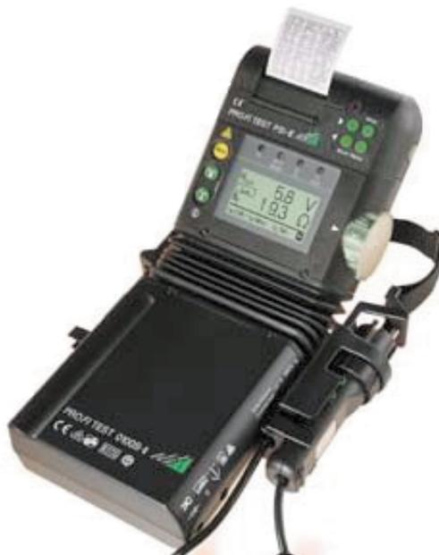
Con el **IC-016** se pueden verificar todas las medidas de protección requeridas según la norma DIN VDE 0100, parte 610, así como por las reglamentaciones internacionales correspondientes (por ejemplo, IEC 364-6-61, HD 364-6-61, S1).
