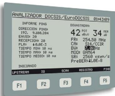
transmitida por el módem o atenuación en la banda de retorno. Este último dato es especialmente importante y el instalador debe verificar que este parámetro se encuentra dentro del margen especificado.
