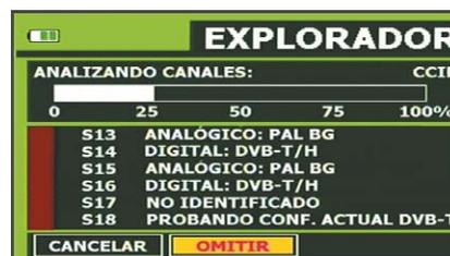
Si el canal es analógico, determina el estándar de televisión de la señal (PAL/SECAM/NTSC).
