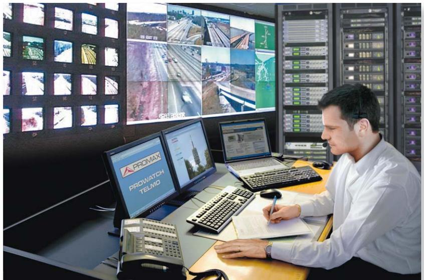
Como ejemplo de una de las aplicaciones adaptadas posibles, un **PROWATCH TELMO** puede supervisar 6 multiplexores TDT y generar ALARMAS y ADVERTENCIAS según el nivel de la señal, VBER o MER. También tiene dos conectores DB25 con relés internos de 70 VDC que pueden ser programados por ejemplo para conmutar una señal defectuosa a otro modulador de emergencia con una señal correcta.
