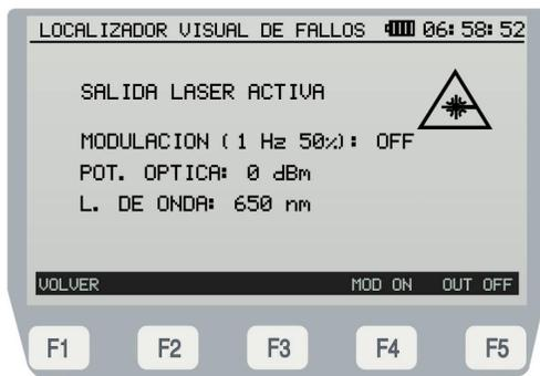
Figura 27.- Pantalla del módulo **LOCALIZADOR DE AVERÍAS** (activo).
