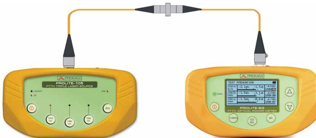
Figure A1. Mesure de la puissance de référence.
