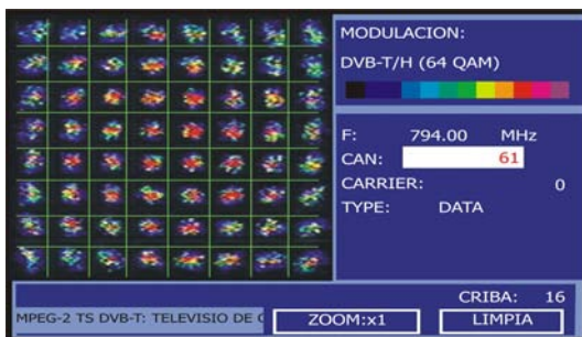
Figura 41.- Diagrama de constelación. Señal DVB-T/H (QAM 64).
