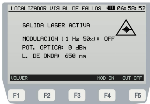
Figura 18.- Pantalla del módulo LOCALIZADOR DE AVERÍAS (activo).
