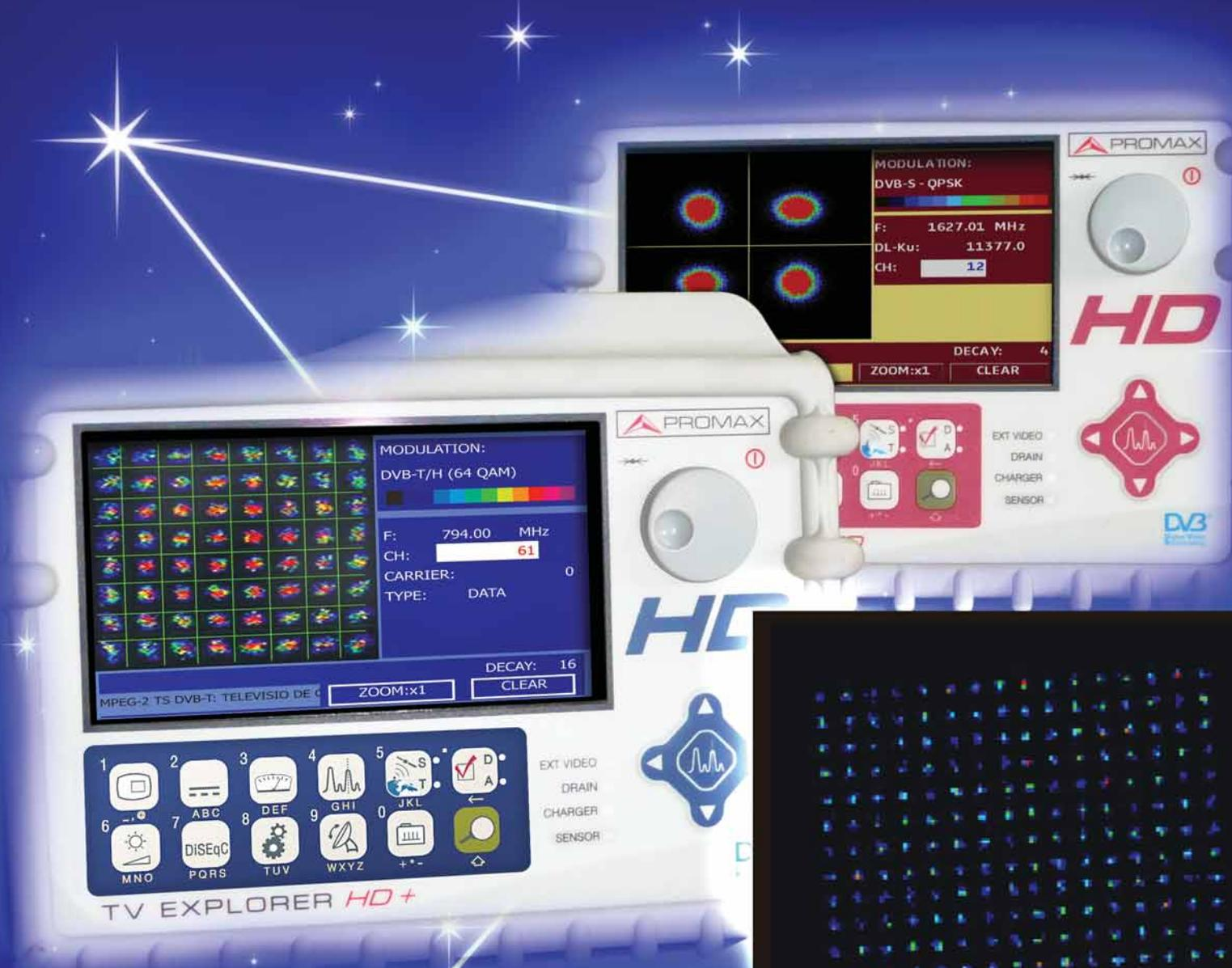
◀ Cada tipo de modulación se representa de forma diferente. Una señal 16QAM se representa en la pantalla por un total de 16 zonas diferentes y una 64QAM se representa por un diagrama de 64 zonas diferentes y así sucesivamente.
