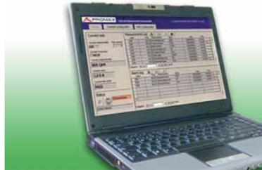
◀ *Diseñado para la monitorización y adquisición masiva de datos utilizado un TV EXPLORER como medidor. Permite almacenar datos, generar gráficos, generar documentos MS Excel y MS Access, etc y generar mensajes SMS de alarma.*
