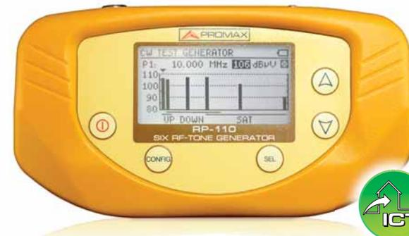
◀ *Generador de señales de test para certificación ICT en todas las bandas de utilización del cable coaxial. Seis pilotos de frecuencia y nivel seleccionables. Puede utilizarse tanto para CATV como para SMATV.*
