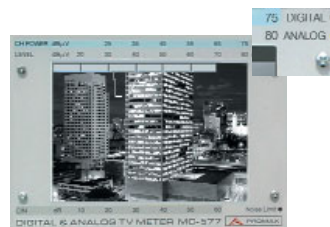
Mesure de niveau + synchronisme
