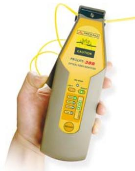
Detección de señal o tráfico y de la dirección de la señal. Un equipo portátil, de bajo coste, y que se puede utilizar con una sola mano.
