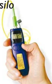
Mini medidor óptico, de 850 a 1625 nm. Margen de medida +10 a -70 dBm.
