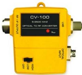
El **CV-100** es un convertor de señal óptica a RF que permite la compatibilidad de los analizadores de TV y Satélite con los enlaces ópticos. El convertor cubre la banda completa RF para satélite FI, terrestre y CATV. Incluye una salida de alimentación continua para dar tensión a la LNB óptica de la antena de satélite.
