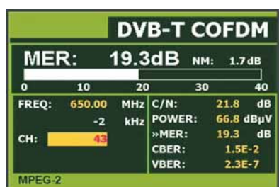
Muestra de una señal de test con datos PRBS
